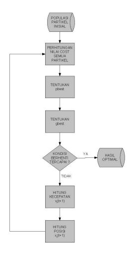
Gambar 2: Diagram alir algoritma PSO
