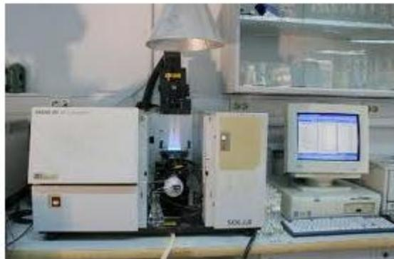
**Gambar 3.3** 1 set Alat Uji SSA (Tipe Parking elmer tahun 2005)
