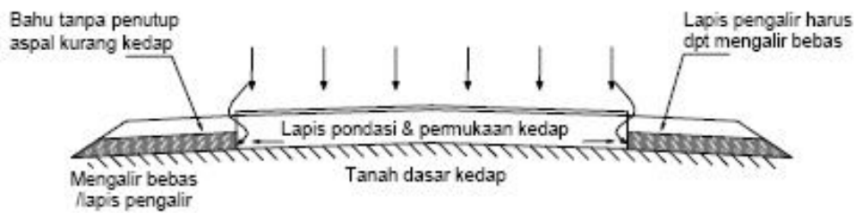
Gambar 4 Ilustrasi Sistem Drainase Melalui Bahu Jalan
