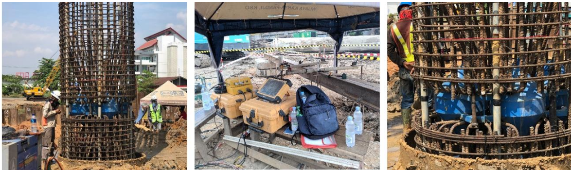
Gambar 13 Pelaksanaan Pengujian Pembebanan Statik Aksial Dua Arah
