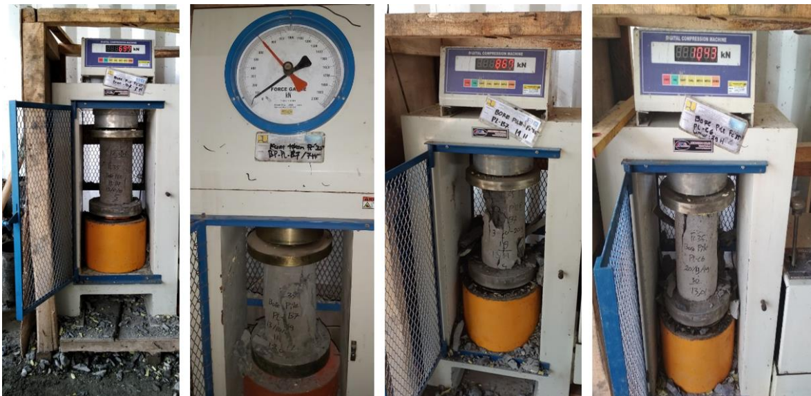
Gambar 11 Pelaksanaan Uji Kuat Tekan Beton
