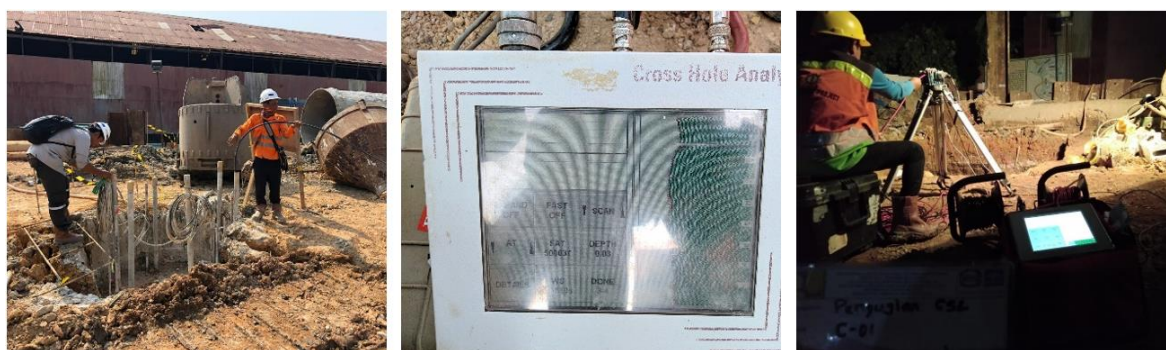
Gambar 16 Pengujian Keutuhan Tiang Bor
