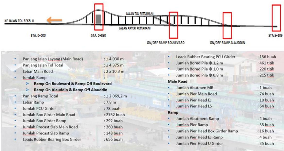
**Gambar 4** Potongan Vertikal dengan Deskripsi Konstruksi Jalan Tol Layang Pettarani
