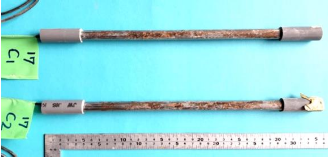
Gambar 8 Produk Korosi yang Terbentuk pada Baja Dalam Beton dengan Kandungan Ion Klorida 10 \text{ kg/m}^3 dan Terekspos Kondisi Kering Tropis Selama 28 Hari
