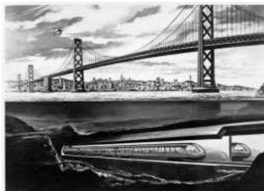
**Gambar 6** Jalur Kereta Api Menggunakan Terowongan Terbenam dengan Konstruksi Tabung Baja di Bawah Jembatan Golden Gate
