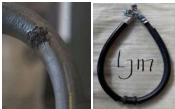
Gambar 2 Selang Rusak (Kiri) dan Selang Kondisi Baik (Kanan)
