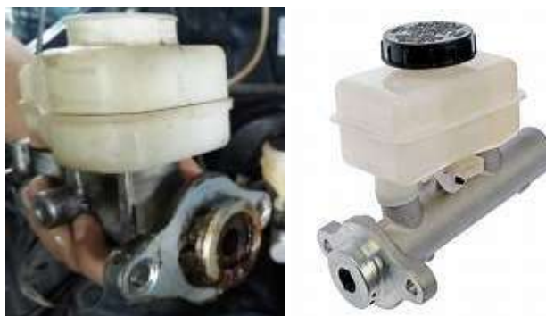
Gambar 3 Master Cylinder Rusak (Kiri) dan Kondisi Baik (Kanan)
