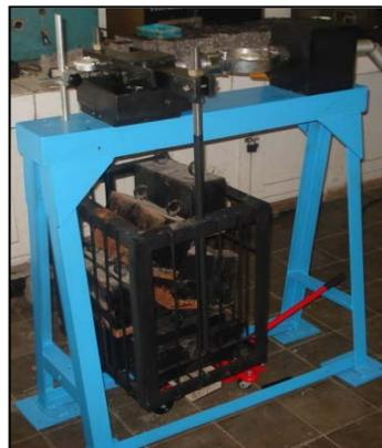
**Gambar 10** Alat *Direct Shear Test* yang Dimodifikasi
