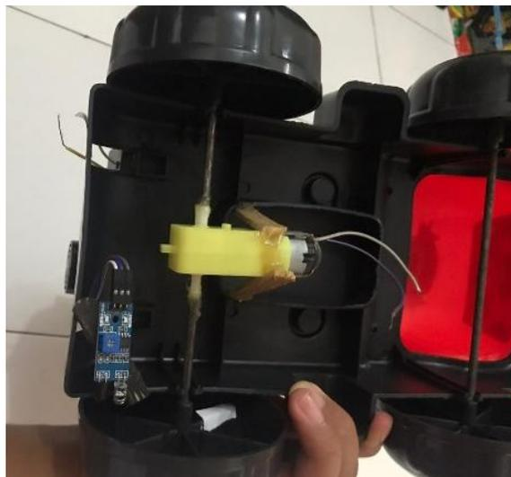
**Gambar 2** Pemasangan *Sensor* Inframerah pada Miniatur Kendaraan
