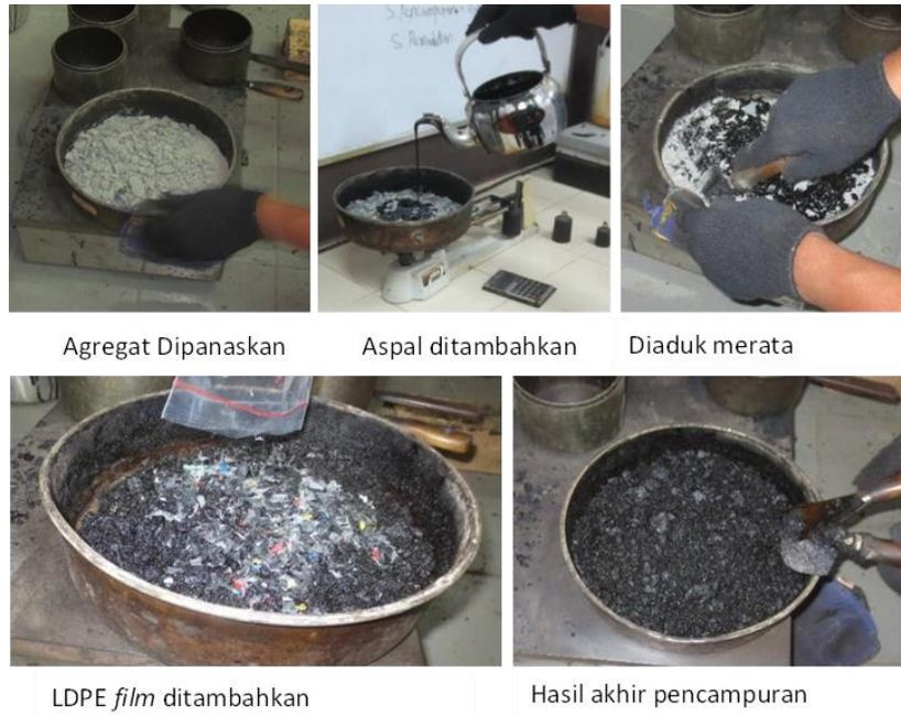
**Gambar 5** Proses Pencampuran Basah
