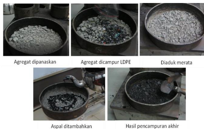
**Gambar 4** Proses Pencampuran Kering
