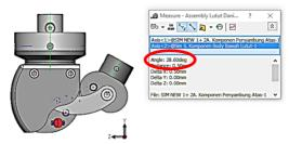
**Gambar 15.** Pengukuran besar sudut penekukan maksimal sendi lutut prostetik usulan
