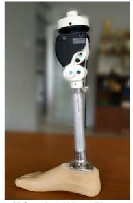
**Gambar 19.**Prototipe akhir sendi lutut yang telah digabungkan dengan bagian bawah lutut
