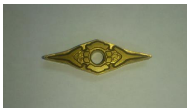
Gambar 9. Insert Tipe VNMG 160408
