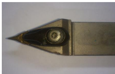
Gambar 8. Holder dan Insert Tipe VNMG 160408
