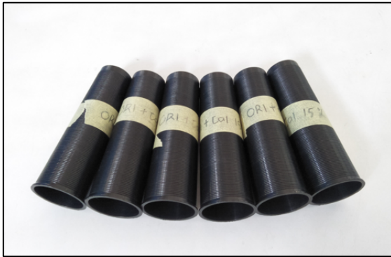
Gambar 5 Produk cone benang dari material PP Murni dan penambahan kalsium karbonat 15%
