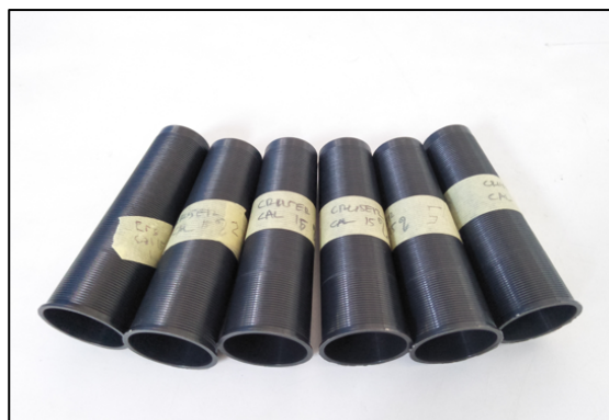
Gambar 4 . Produk cone benang dari material PP daur ulang dan penambahan kalsium karbonat 15%
