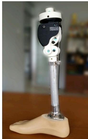
**Gambar 19.** Prototipe akhir sendi lutut yang telah digabungkan dengan bagian bawah lutut
