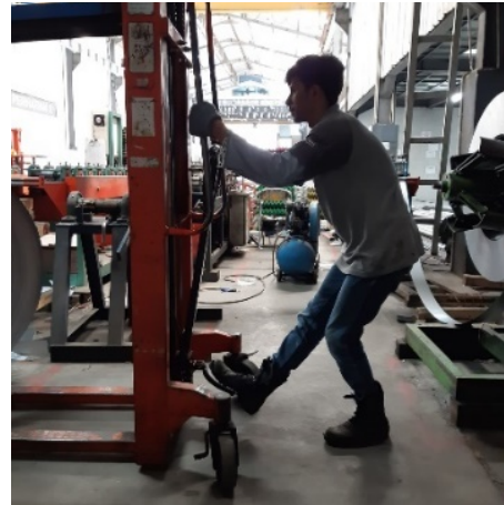
Gambar 3. Postur memompa handstaker sebelum perbaikan
