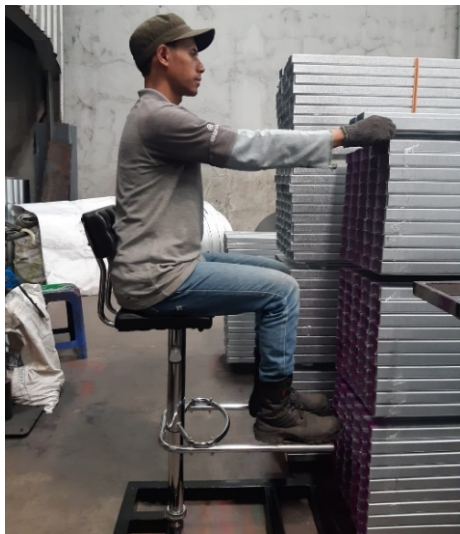
Gambar 7. Postur menyusun produk setelah perbaikan
