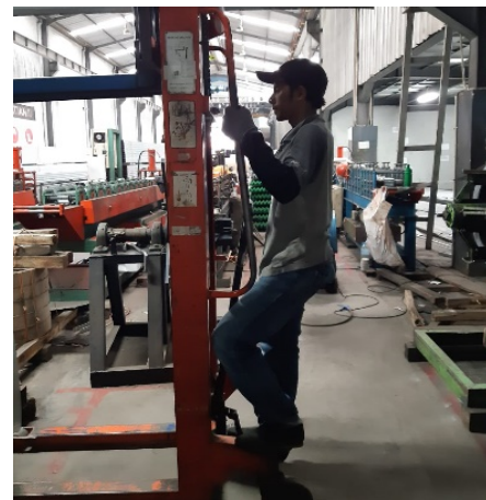
Gambar 4. Postur memompa handstaker setelah perbaikan
