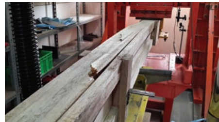
Gambar 10 Ragam Kegagalan Lentur Benda Uji 2.
