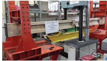
Gambar 5 Uji Kuat Lentur Balok Kayu Benda Uji 3.
