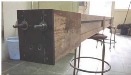
Gambar 3 Pemasangan Tulangan Pratekan Pada Balok Kayu.
