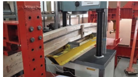
Gambar 11 Ragam Kegagalan Lentur Benda Uji 3.
