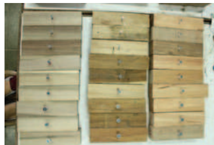
Gambar 2 Benda Uji Kuat Cabut Sekrup (Sengon- Akasia-Meranti).
