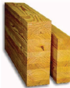
Gambar 1. Beberapa lamina kayu yang direkatkan dengan bahan adhesif menjadi glulam [1]
