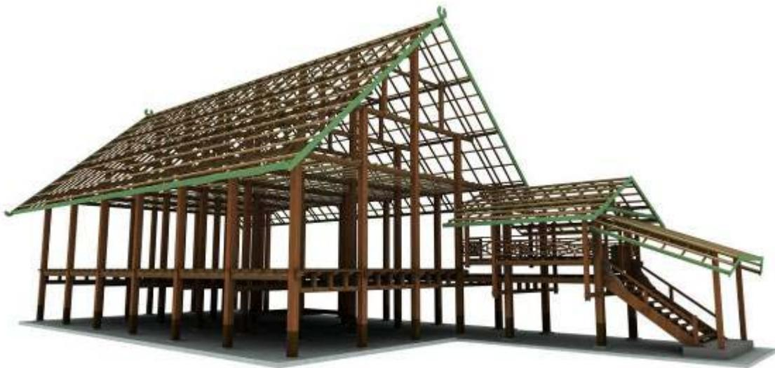
**Gambar 2.14.** 3 dimensi sistem struktur Bola Soba.
