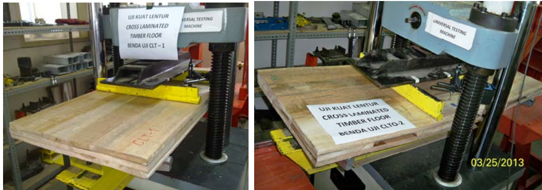
Gambar 5.5. Benda uji lantai CLT saat pengujian dengan third point loading test
