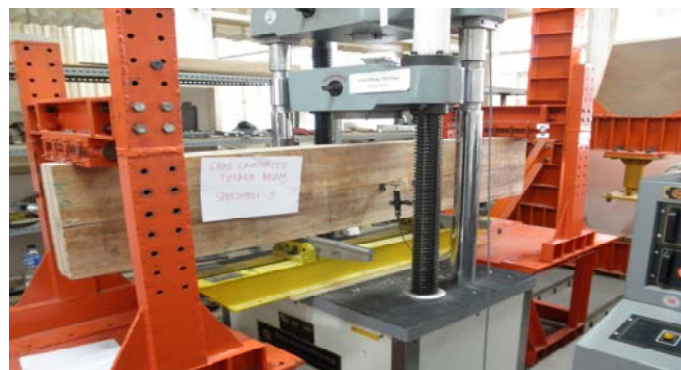
Gambar 4.3. Pengujian benda uji pada UTM dengan third point loading
