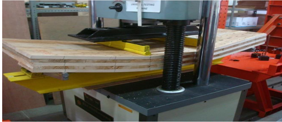
Gambar 2.16 Uji lentur dengan two point loading
