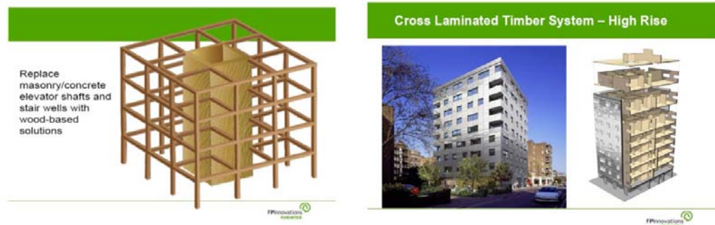
Gambar 2.1 Struktur bangunan kayu dengan konstruksi dinding geser CLT untuk apartemen perumahan di United Kingdom, Sumber: Forintek 2008.
