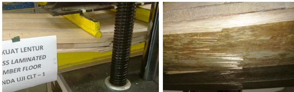
Gambar 5.8. Keruntuhan Tarik akibat lentur pada bagian bawah lantai CLT
