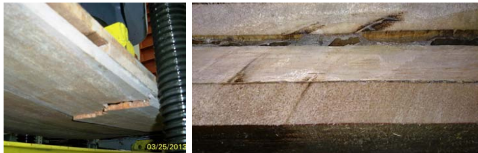
Gambar 5.9. Keruntuhan tarik pada bagian tengah (kiri) dan terpisahnya perekat (kanan).
