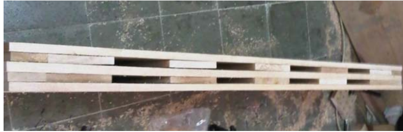
Gambar 2.4. Tampak atas benda uji balok papan kayu laminasi silang dengan paku
