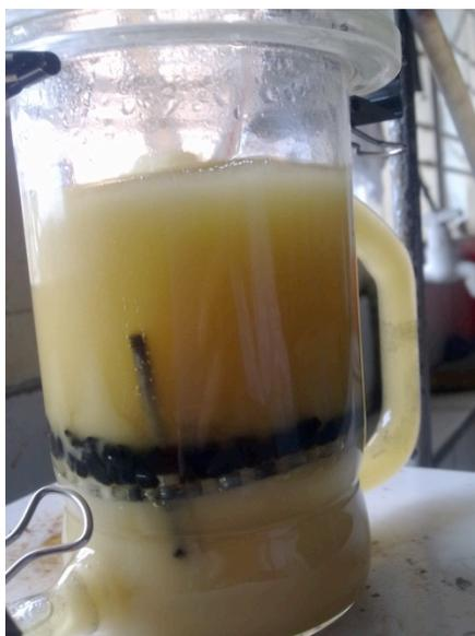
**Gambar 4.6** Proses hidrogenasi pada  $65^{\circ}\text{C}$
