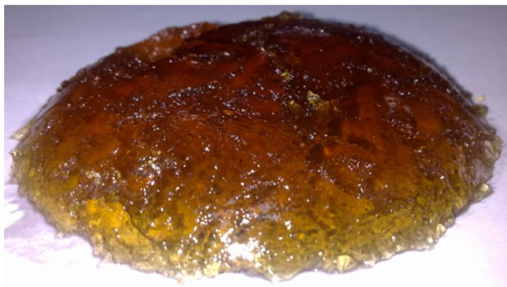
**Gambar 4.3** Struktur minyak kapok yang terpolimerisasi
