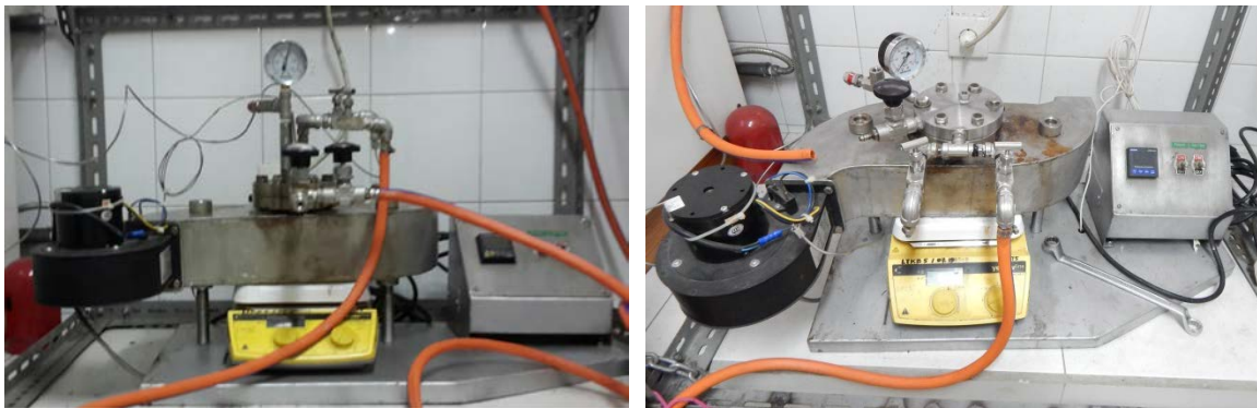
(a) (b) Gambar 4.1 Reaktor HDO (a) Sebelum Modifikasi (b) Setelah Modifikasi
