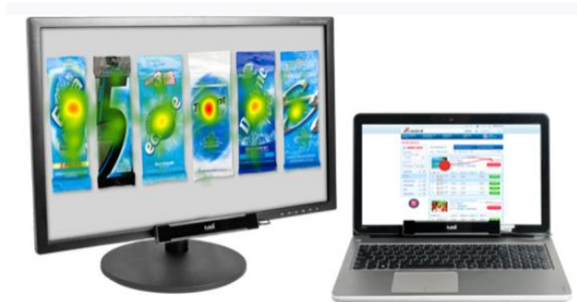
Gambar III.18. Eye tracker X2-30 yang digunakan untuk penelitian (Sumber: http://www.tobii.com/ )
