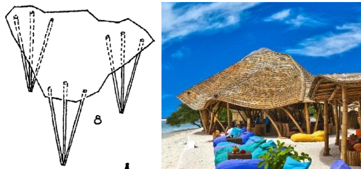
Gambar 3.3 Dasar Prinsip Struktur dari Bangunan ' Pearl Beach Lounge' sumber : Kramer, Karl. (1985) (a) dan www.tripadvisor.com (b)
