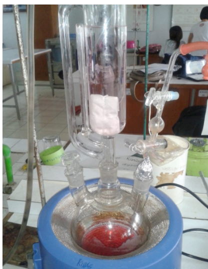
Gambar 4.1 Rangkaian Ekstraksi Soxhlet
