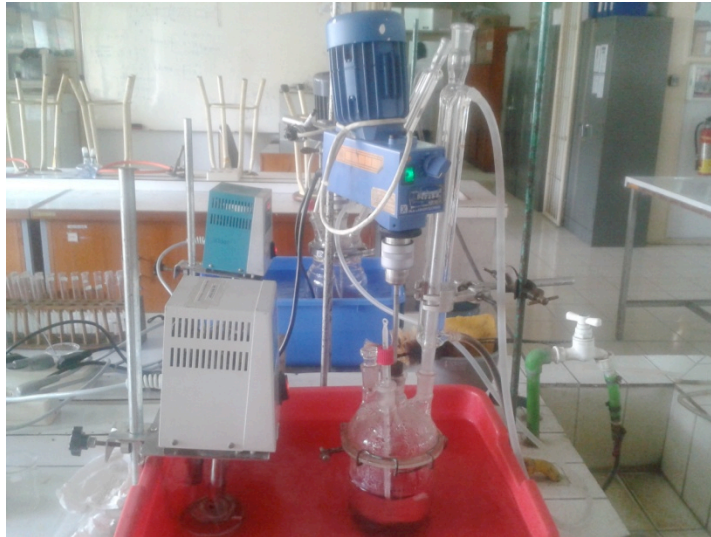
Gambar 4.3 Rangkaian Alat Ekstraksi Batch Berpengaduk
