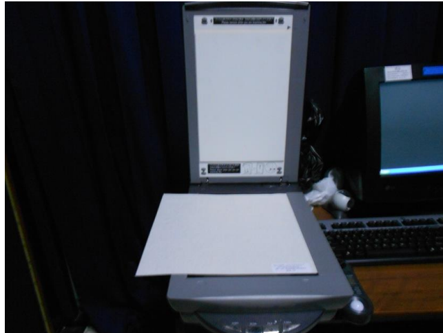
Gambar 2.6 Sistem pengukuran temperatur menggunakan TLC dan scanner [8]
