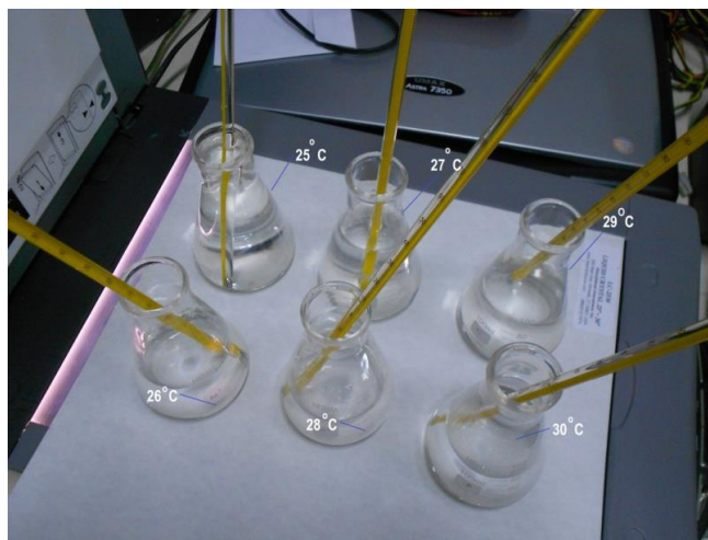
Gambar 2.7 Kalibrasi TLC menggunakan wadah labu Erlenmeyer bersuhu (25-30)°C [8]
