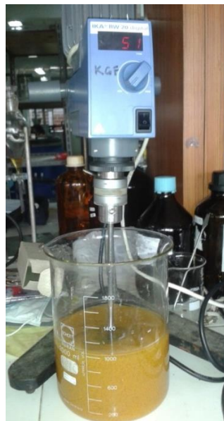
Gambar V.12 Rangkaian Alat dalam Proses Koagulasi
