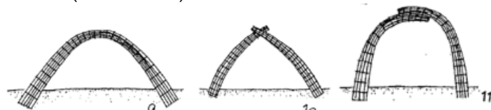
Gambar 0.6 Batang yang Digabung Menjadi Satu Ikatan untuk Membentuk Elemen Lengkung
