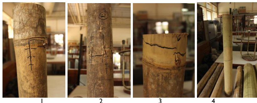
Gambar 5.2 Tipe Kerusakan pada Bambu Tali Utuh: crushing pada kulit bambu area ruas (1), crushing kulit bambu pada area tengah (2), shearing pada area ruas (3), shearing pada area tengah (4)
