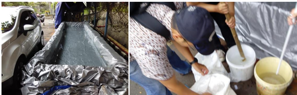
Persiapan Bak Rendam sebesar 1,5 m x 8m dan Pembuatan Larutan Borax Boric Acid 5%
