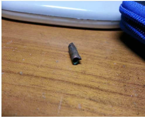
Gambar 4.3 Pipa Tembaga untuk Katoda
