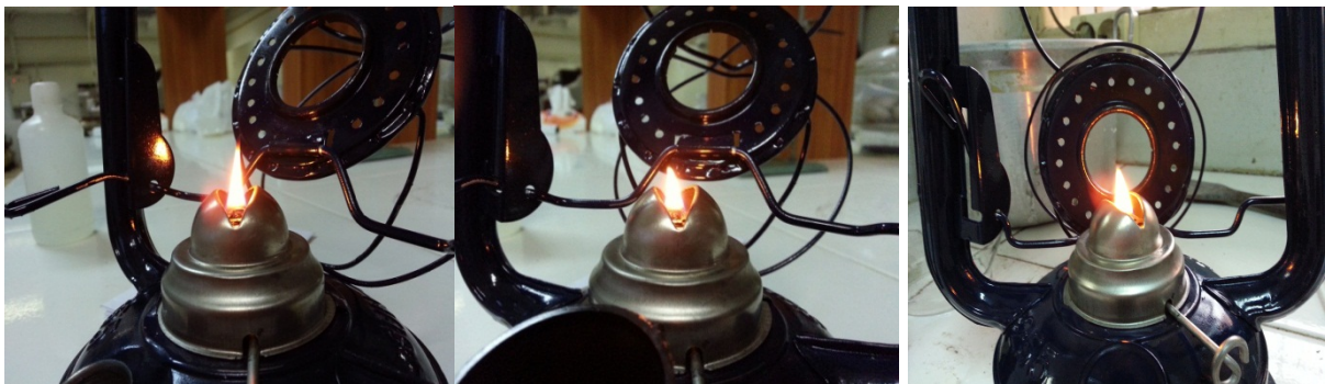
Gambar 4.11 Uji Nyala Api : (a)Kerosin; (b)Terpentin Murni; (c)Hasil Hidrogenasi
