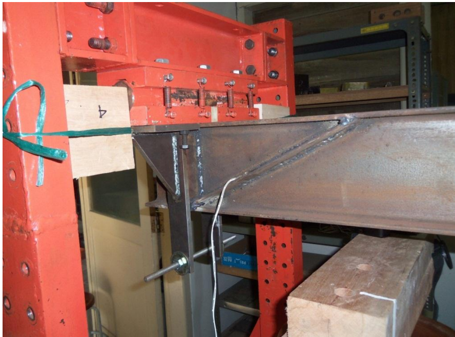
Gambar L-8 Pengaku miring dengan kemiringan 1:2
