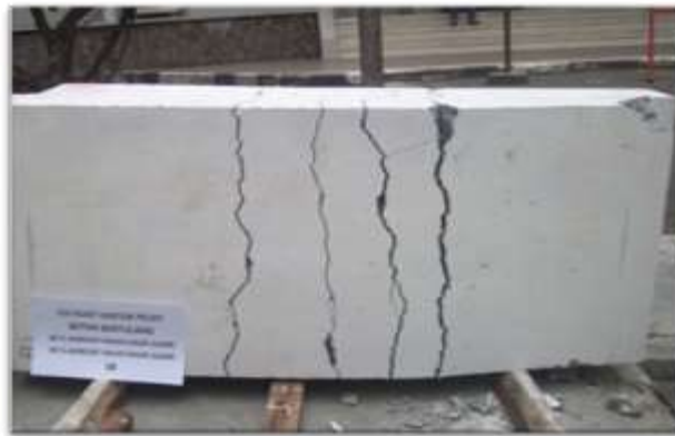
Gambar 5.5 Pelat Bertulang Pola Retak Beton
