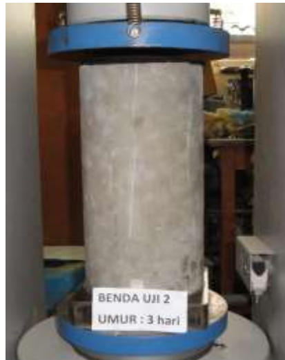
Gambar 3.4 Uji Kuat Tekan dengan Compression Testing Machine
