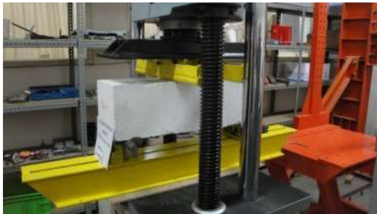
Gambar 4.1 Pengujian Lentur Balok Beton Tanpa Tulangan dengan UTM
