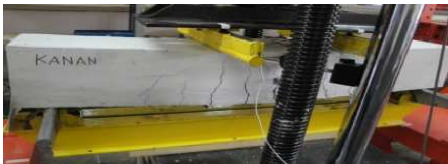
Gambar 4.3 Pengujian Lentur Balok Beton Bertulang dengan UTM
