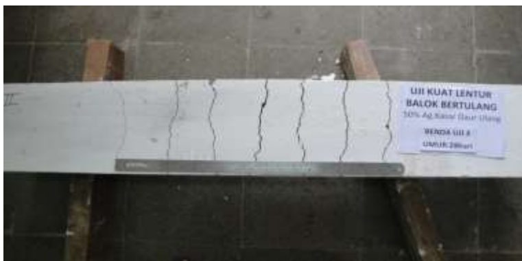
Gambar 4.6 Pola Retak Akibat Uji Lentur Pada Balok Beton Bertulang 50% RCA
