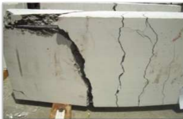
Gambar 5.6 Pola Retak dan Lepasnya Bongkahan Beton pada Benda Uji
