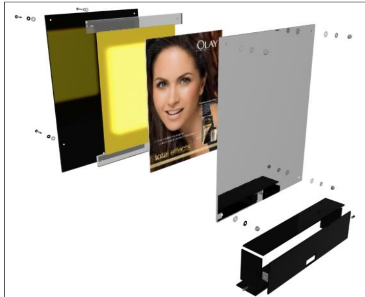
Gambar V.4 Exploded View Prototipe Produk Cermin Iklan
