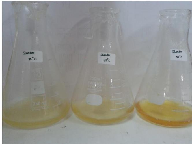
**Gambar V.3.** Pengujian bilangan peroksida
