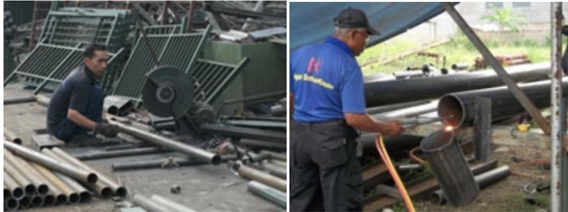
*Pemotongan baja pipa dengan alat potong (kiri) dan pemotongan dengan menggunakan panas tinggi (kanan)*
