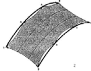
**Permukaan membran yang dijepit berupa titik ke busur pendukung**
