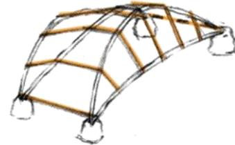
Gambar 5.17 Batang tarik yang juga akan mengalami tekan pada penyaluran beban lateral pada "Mepantigan" Green School
