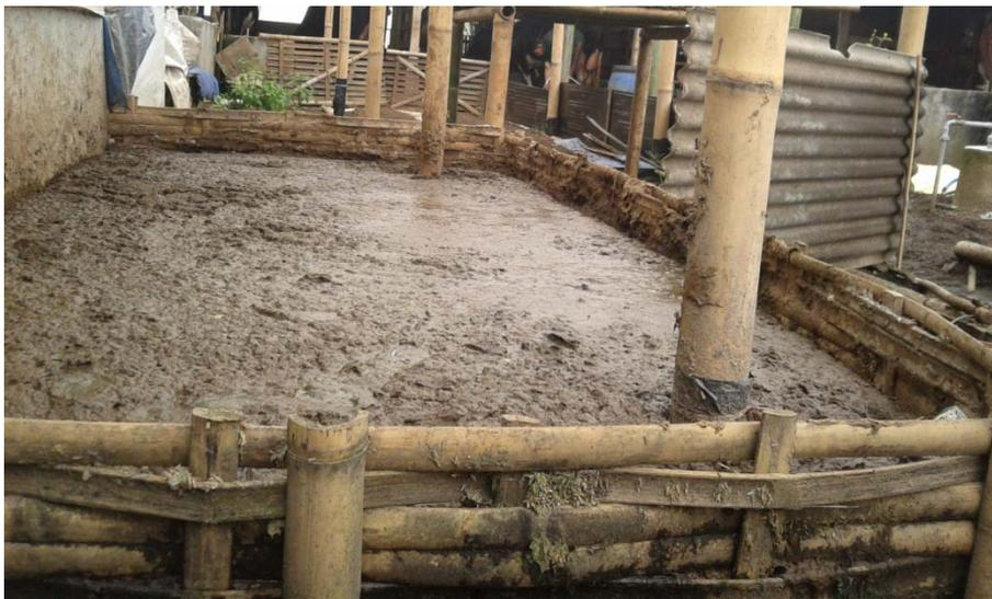
Gambar 2.2: *Bioslurry* hasil tampungan dari reaktor biogas
