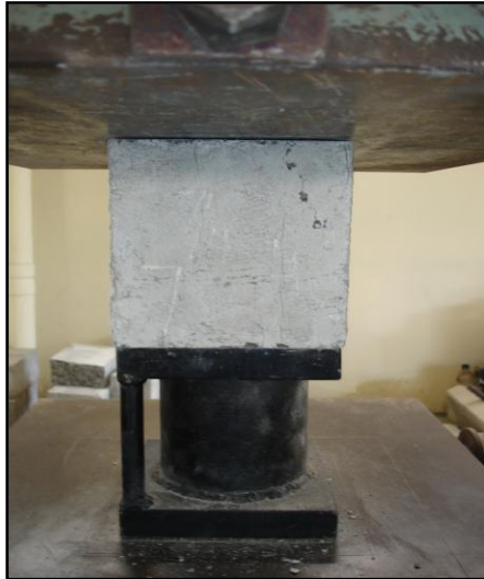
Gambar 15. Uji kuat tekan kubus beton dengan styrofoam
