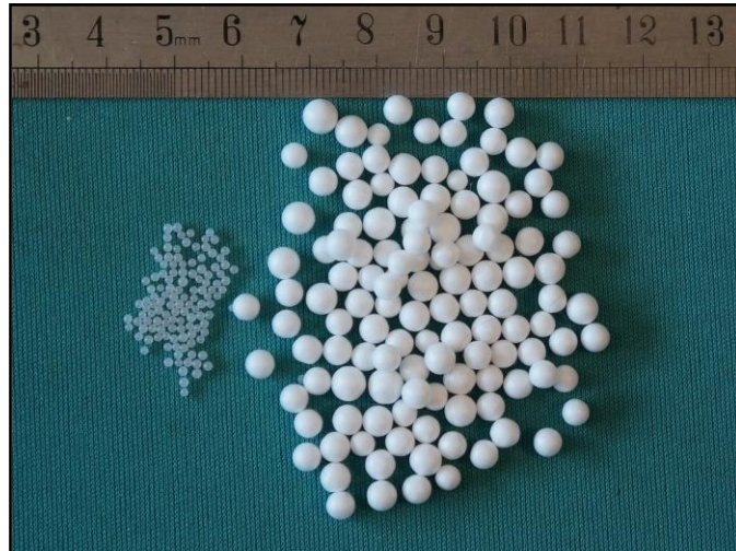
Gambar 2. Ukuran butiran expandable dan expanded polystyrene produk PT BEP
