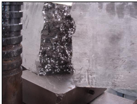
Gambar 17. Penampang balok beton styrofoam setelah uji kuat lentur
