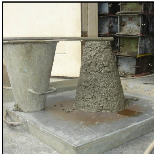
Gambar 2. Uji slump beton dengan 80% EPS
