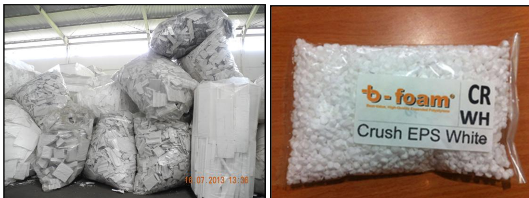
Gambar 9. Limbah styrofoam kemasan produk sebelum dan sesudah dicacah di PT BEP
