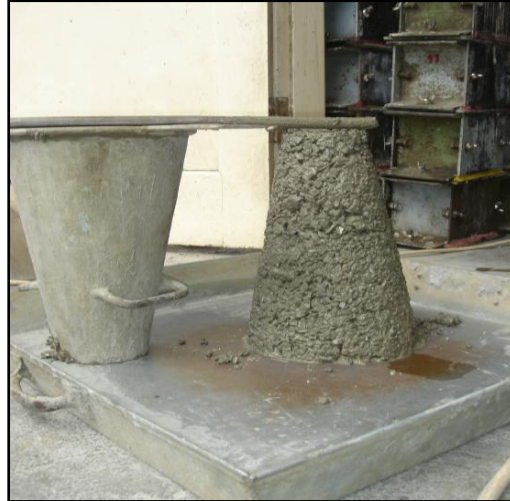
Gambar 14. Uji slump beton dengan 80% Styrofoam
