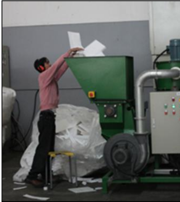
Gambar 10. Mesin pencacah limbah styrofoam kemasan produk di PT BEP
