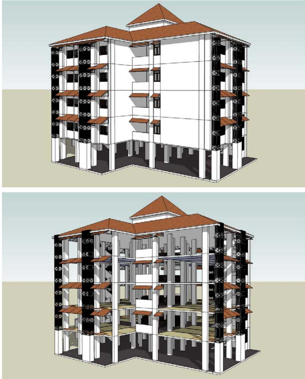
Gambar 4.16. Breakdown Kulit Bangunan
