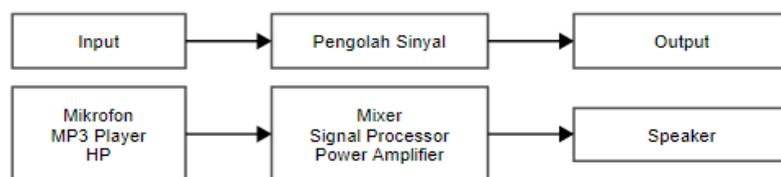
Gambar 2. Skema Sistem Tata Suara secara Umum
