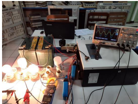
Gambar 5. Pengujian laboratorium Off-Grid Photovoltaic Solar Power System dengan beban linier
