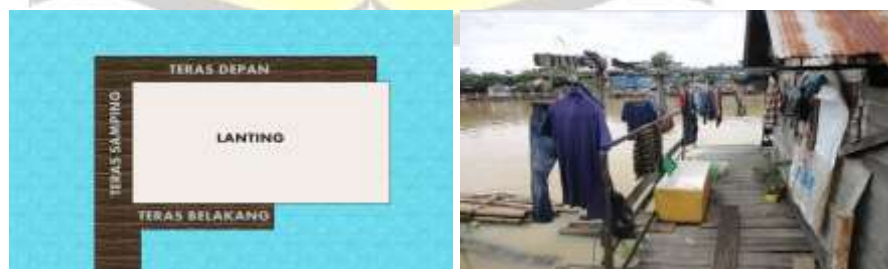
Gambar 7. Teras Pada Rumah Lanting
